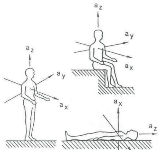
**Figura 1.** Mediciones de Aceleración en el Sistema Coordinado Biodinámico (Adaptado de ISO 2631) ax, ay, az =aceleración en la dirección de los ejes x, y, z; eje x=espalda hacia pecho; eje y= de derecha a izquierda; eje z= de los pies a la cabeza.
